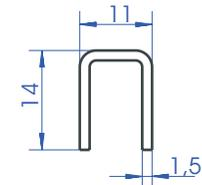
Maßerfassungsblatt für **Schwimmbadrost Typ PG**, starrer Lamellenrost mit **querlaufenden, gebogenen, U-förmigen** Lamellen, **verpresst**
