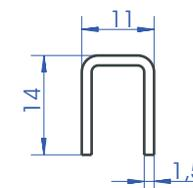
Maßerfassungsblatt für **Schwimmbadrost Typ PG**, starrer Lamellenrost mit **querlaufenden, U-förmigen** Lamellen, **verpresst**
