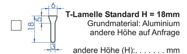
Maßerfassungsblatt für **Stabrost Typ SG**, starrer Lamellenrost mit **querlaufenden** Lamellen, **verpresst**
